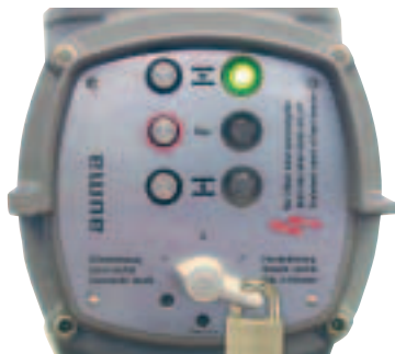
Средства местного управления AUMA MATIC с нажимными кнопками, селекторными переключателями и индикаторными лампами.
